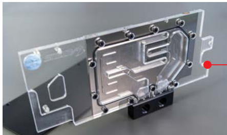
Blok wodny jednej z najpopularniejszych firm - EKWB - przeznaczony dla karty graficznej Gigabyte AORUS GTX 1080Ti Xtreme Edition
