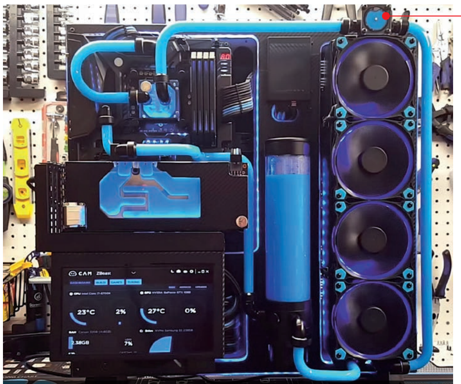
To jeden ze zmodyfikowanych komputerów powstały w obudowie Thermaltake Core P5 - Open Core. Układ chłodzenia wodnego jest skomplikowany i poza blokiem na kartę graficzną i procesor chłodzi również sekcję zasilania płyty głównej, a następnie okrąża całą chłodnicę, którą autor zamontował odwrotnie
