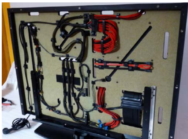
Tak wygląda efekt ułożenia kabli z wykorzystaniem opasek zaciskowych
