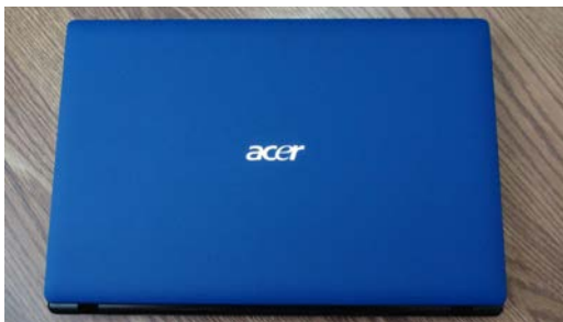
Górna pokrywa laptopa pomalowana plastidipem – spray kryje równomiernie i oferuje atrakcyjny kolor
